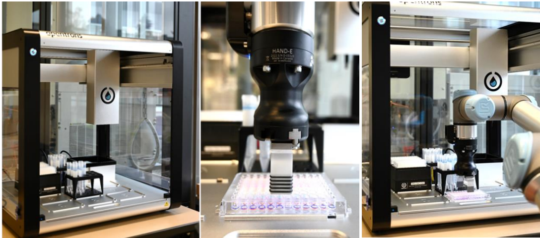
Abbildung 1: Opentron (Pipettierroboter) (links); Robotergreifarm mit Mikrotiterplatte (mitte); UR5e Roboterarm (rechts)
